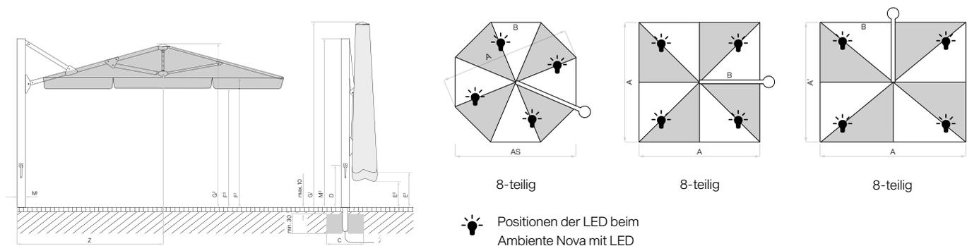
Loser Deckbelag max. 10 cm, Betondicke min. 30 cm (Frosttiefe beachten), Wasserabfluss gewährleisten, Zuleitung elektrisch.
